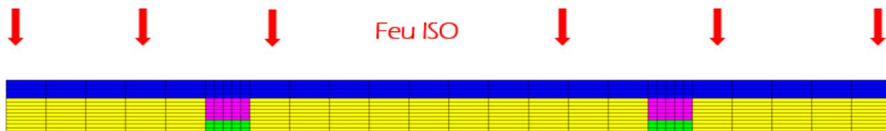
Figure 5 : Section modélisée sous SAFIR avec revêtement Fermacell.
