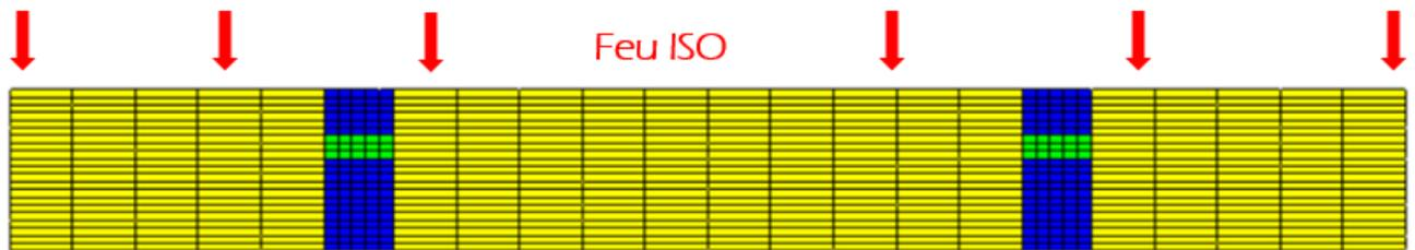
Figure 3 : Section modélisée sous SAFIR avec maillage structuré.
